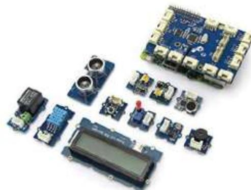
Der Vorteil an der GrovePi-Welt ist, dass alles über einen Standard-Anschluss mit einander kommuniziert und die Module bereits fertig aufgebaut geliefert werden. Normalerweise muss
