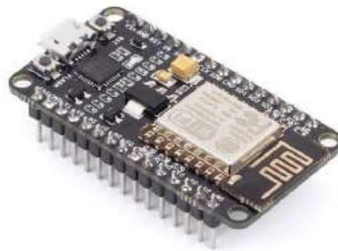
Zu den beliebtesten Modellen gehört der ESP8266 – ein Chip der chinesischen Firma espressif<sup>6</sup>). Das Stück kostet ist ab 2 Euro. Das Betriebssystem, das auf dem Chip läuft, heißt NodeMCU. Es kann zum Beispiel über die Arduino-IDE programmiert werden. Die Schülerinnen und Schüler lernen hier exaktes Arbeiten, denn sobald der Code auf den ESP übertragen wurde, kann er nicht mehr verändert werden. Man müsste stattdessen den gesamten Code neu aufspielen.
