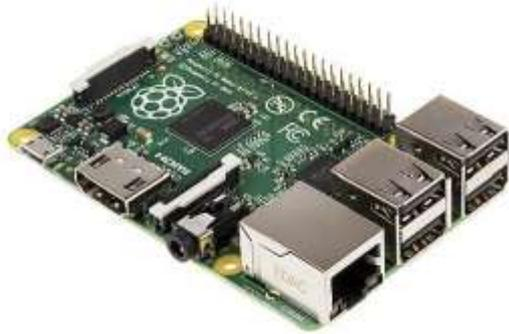
Eine weitere Eigenschaft, die ihn besonders macht, ist die Möglichkeit, eigene Sensoren und externe Geräte anzuschließen und darüber anzusteuern. Dazu steht eine Reihe von I/O (Input/Output)-Pins zur Verfügung.
