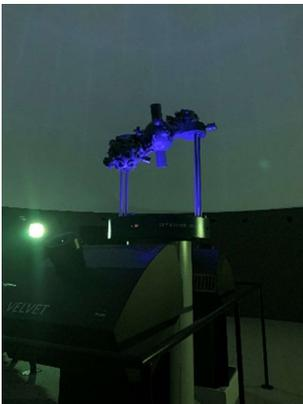
*Abb. 1 Optomechanischer Projektor im Planetarium*
