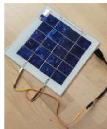
Nachdem wir alles aneinander gelötet haben, haben wir eine Glasplatte ausgeteilt bekommen, diese gesäubert und sie dann vorsichtig auf die Solarzellen gelegt. Auf beide Seiten der Glasplatte kam noch eine Folie, um das Solarmodul zu schützen. Das Bild rechts zeigt die Maschine, die das Solarmodul laminiert hat:
